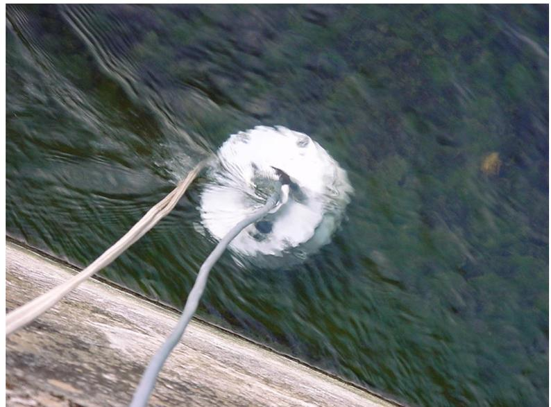
Figure 5. Immersion dans l'eau. Masse de la sonde : 7,5 kg
