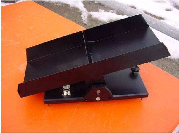
Figure 1. Doseur à augets. La capacité d'un auget est de 100 à 110 ml.
