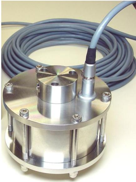
Figure 4. Sonde de fluorimètre de terrain GGUN-FL30. Diamètre 160mm
