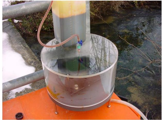
Figure 2. Enceinte de protection contre le vent. Un vase de Mariotte délivre la solution de traceur avec un débit constant.
